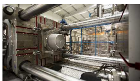
Blick in eine der Spritzgießmaschinen, die aus Recyclingmaterial Behälter für viele Kunden in Europa herstellt
